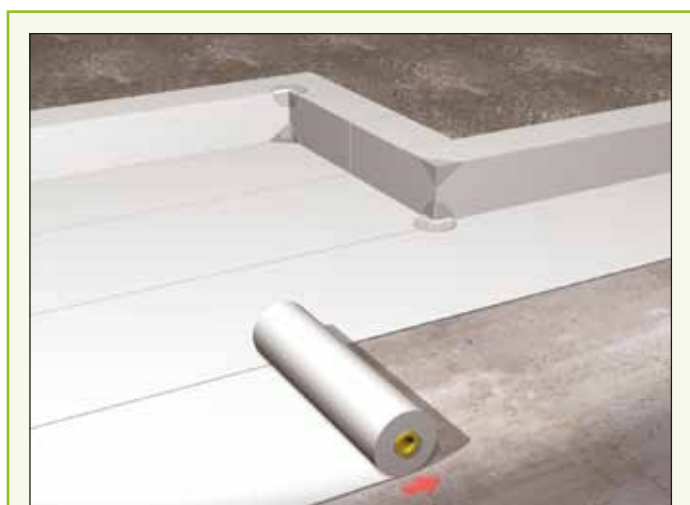
Protan RadonSafe kan monteras både i användningsklass B och C. Våderna skarvas med varmlufts svetsning, vilket ger en bra tätthet mot Radon.
